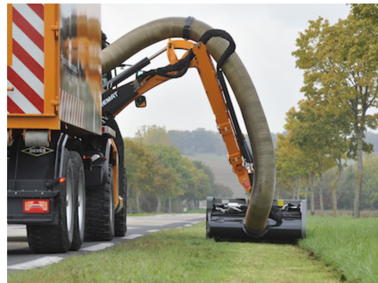
Fauchage de bord de route avec exportation par aspiration (source : Noremat)
